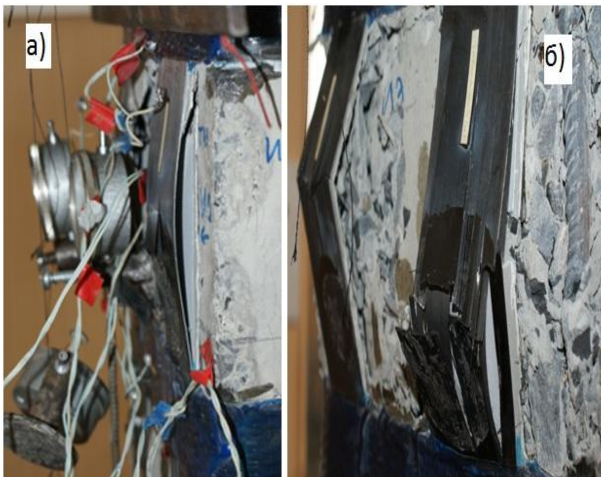
Рис.4.1. Выпучивание на участке между хомутами (а) и разрушение ламината от излома при нагрузке 70-80% от разрушающей (б)
