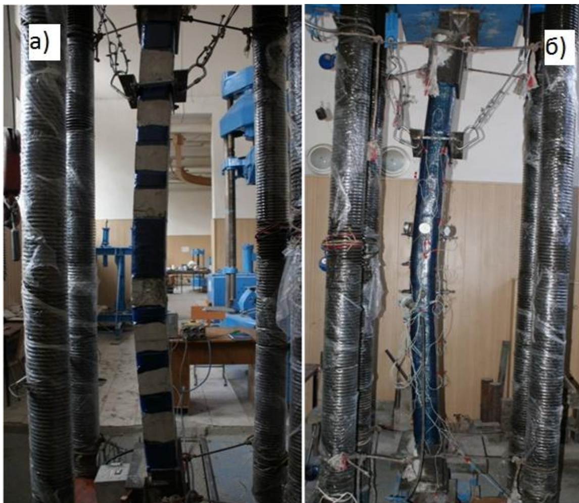
Рис.4.2. Влияние прерывистого (а) и полного обертывания (б) гибких стоек углепластиком на их деформативность
